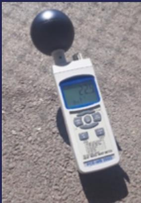
**1- Thermomètre à boule noire pour la mesure de température ressentie (Wet Bulb Globe Temperature, WBGT).** L'indice WBGT (Wet Bulb Globe Température) a été créé spécialement pour réduire le risque de traumatismes liés au stress thermique afin de déterminer les niveaux d'exposition à des températures élevées. Il tient compte non seulement de l'ensoleillement mais également du refroidissement éolien et de la couverture nuageuse. Il prend en compte trois mesures :
