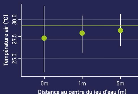
Température de l'air (°C) mesurée à 0m, 1m, 5m des aires de jeux d'eau Saige (à gauche) et Haut Livrac (à droite) (29.08.19). Lignes vertes = température de l'air enregistrées par la station météorologique la plus proche (Lycée V. Louis)
