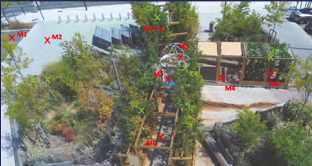
Illustration des points de mesure (en rouge les points de mesure monitorés par l'opératrice, en vert les capteurs fixes)
